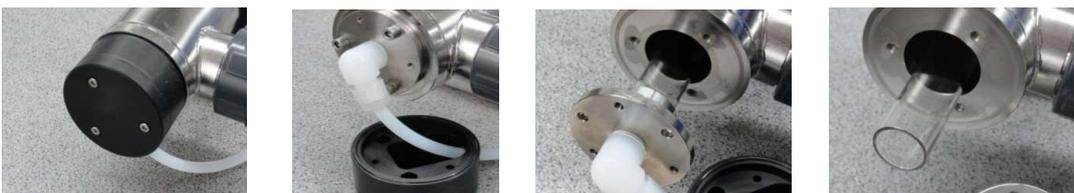
schraubung ein wenig verdrehen, um an den dritten Schraubenkopf zu kommen. Bevor Sie den Flansch abnehmen, halten Sie das obere freie Ende des Quarzglashüllrohres mit einem Finger, um es vor einem Aufschlagen an die Reaktorinnenwand zu schützen.
